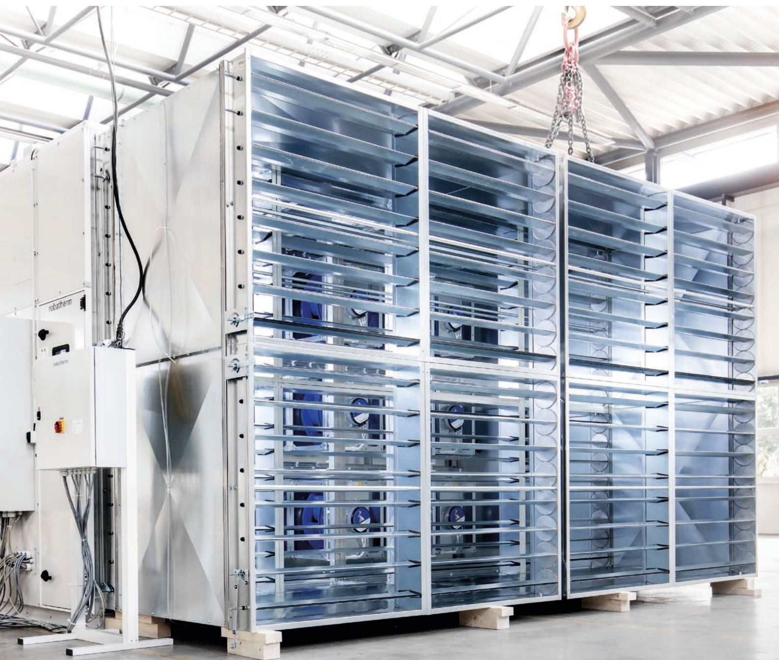
Přijímací zkouška vzduchotechnické jednotky s ventilátorovou stěnou ve výrobním závodě.
